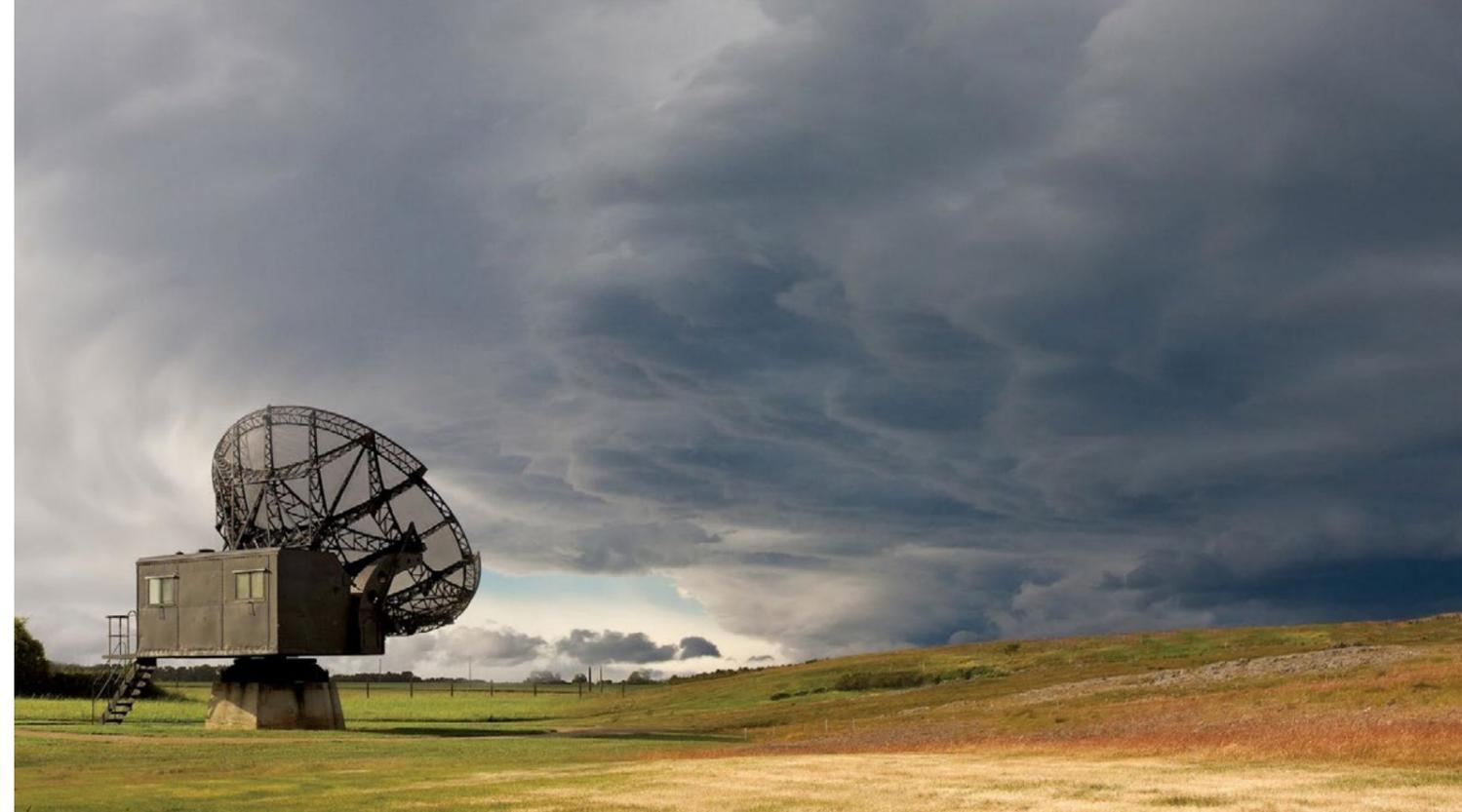
Современные радарные установки могут определять положение самолетов и других движущихся объектов в воздушном пространстве. Для этого они отслеживают, как пучки электромагнитных волн отражаются от поверхности объектов. Соответственно, противодействующие им стелс-технологии — то есть способы снижения заметности боевых машин — или пропускают эти колебания через себя, или полностью поглощают все падающие на них волны.
