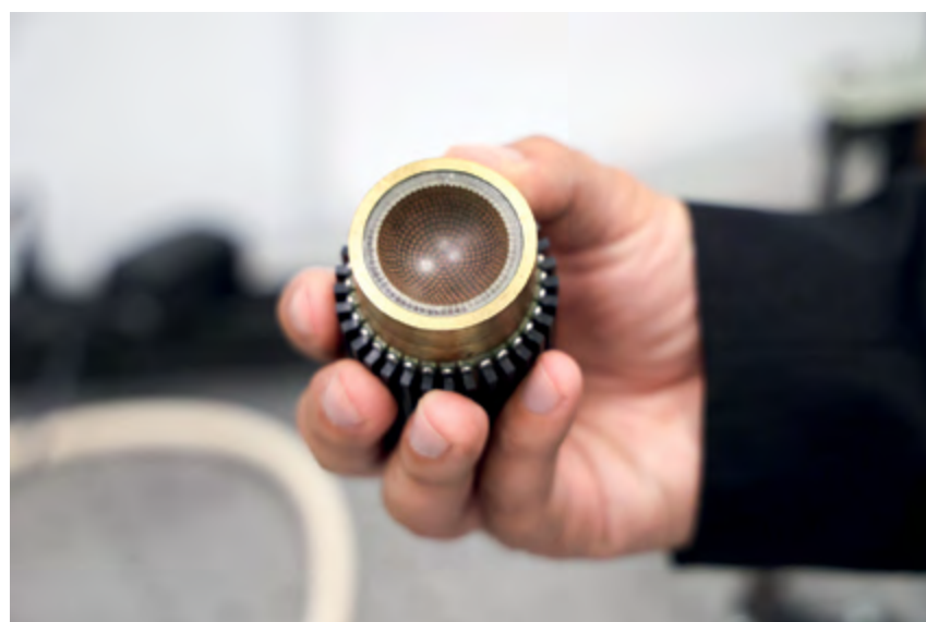
Крупный план сферической антенны, показывающий миниатюрные пьезоэлементы. Источник: пресс-служба ИПФ РАН
