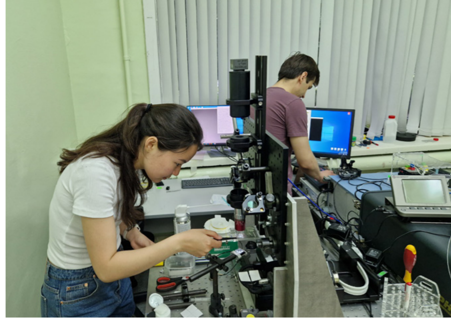
Магистрант Жибзема Мункуева записывает 3D-структуры фемтосекундным пучком, структурированным с помощью пространственного модулятора света. Источник: Наталья Коляда
