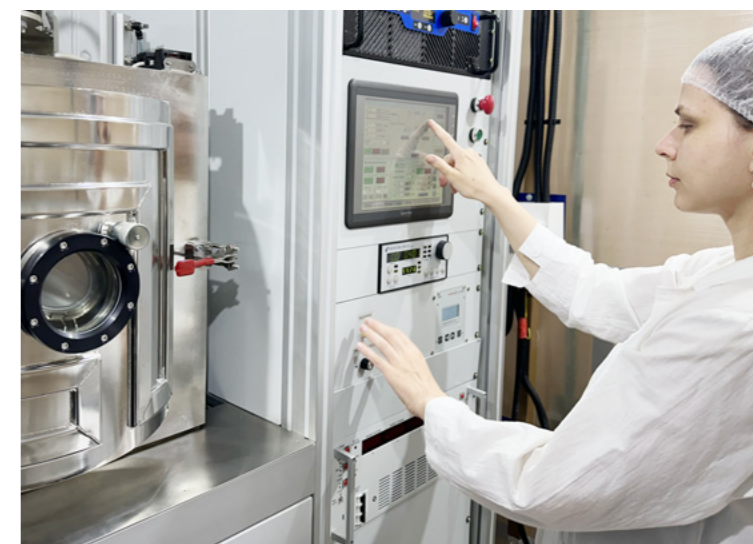
Старший научный сотрудник Алена Казакова отрабатывает процесс нанесения металлических контактов на поверхность полупроводниковой лазерной гетероструктуры. Источник: лаборатория полупроводниковой люминесценции и инжекционных излучателей
