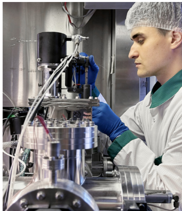
Младший научный сотрудник, аспирант Артем Гришин проводит процесс эпитаксиального роста гетероструктур на установке МОС-гидридной эпитаксии. Источник: лаборатория полупроводниковой люминесценции и инжекционных излучателей
