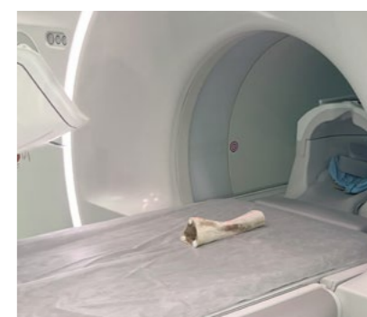
Образец цементного материала в томографе. Источник: Полина Крохичева
