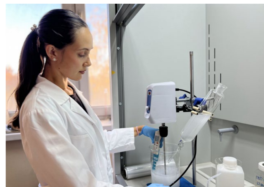
Процесс получения цементного порошка методом химического осаждения. Источник: Полина Крохичева
